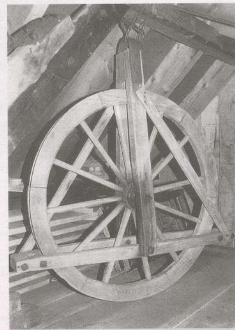
Das Wellrad. In der ehemaligen Brennerei Elmendorf befindet sich dieses Aufzugsrad von 1881 für eine Last von einem Doppelzentner.
