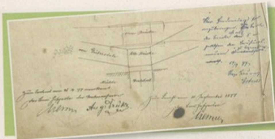
VERÄNDERUNG DER STRASSENFÜHRUNG DER ALTEN OSNABRÜCKER ZOLLSTRASSE ANLÄSSLICH DES BRÜCKENNEUBAUES 1877. Anstatt wie zuvor ein kleiner Linksbogen wurde der Straßenverlauf jetzt gerade geführt. Dadurch kommt die neue Brücke unmittelbar oberhalb der alten zu liegen. Quelle: LAV NRW OWL, M 1 RHK Nr. 153, fol. 753v Auszug aus den Erläuterungen zur Skizze: „... Die Fundamentmauer liegt 60 cm unter der Oberkante des Fachbaumes. Das Gewölbe wird mit wölbeförmigen glasharten Backsteinen (Normalformat) hergestellt. Die Abdeckung der Brustmauer erfolgt mit dem gleichen Material in Zementmörtel mit Sandsteinquadern auf den Ecken.“
