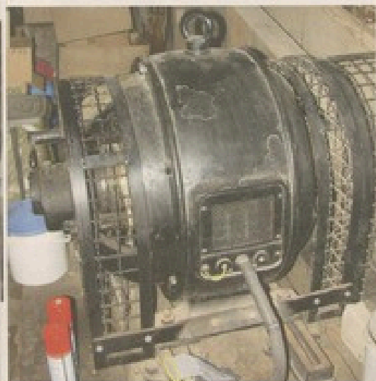
■ ELEKTROMOTOR ALS HAUPTANTRIEB, BAUJAHR 1921, LEISTUNG 15 KILOWATT BEI 965 U/MIN Foto: Stadt Gütersloh
